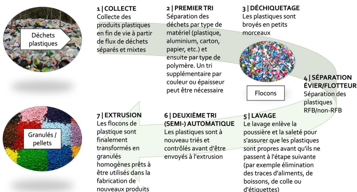
Figure 24 - Processus de recyclage mécanique du plastique (élaboration UNITAR à partir de Plastics Europe, 2022 ; Bills et. al., 2019 )
