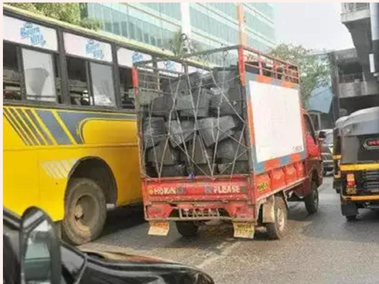
**Figure 3** - Exemple de mauvaise pratique : téléviseurs à tube cathodique empilés dans un camion ouvert pouvant entraîner des dommages pendant le transport ©Times of India
