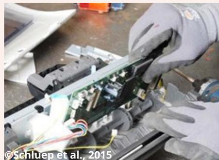
4. Retirez le moteur de l'imprimante. Si possible, séparez la bobine de cuivre ou les aimants à l'intérieur du moteur. Les aimants doivent être stockés séparément.
