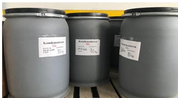
**Figure 29** – Fûts spéciaux pour le stockage et la manipulation des condensateurs et accumulateurs considérés comme des déchets dangereux ©Deepali Sinha Khetriwal
