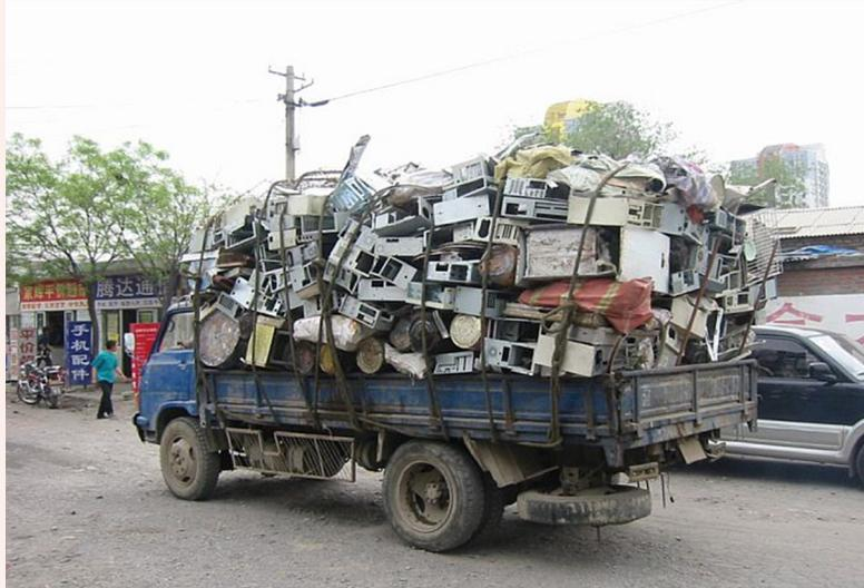
**Figure 4 -** Exemple de mauvaise pratique : camion ouvert transportant des déchets électroniques incorrectement empilés et fixé qui se déversent à l'extérieur des bords du camion et présentent un risque élevé de chute ©EMPA
