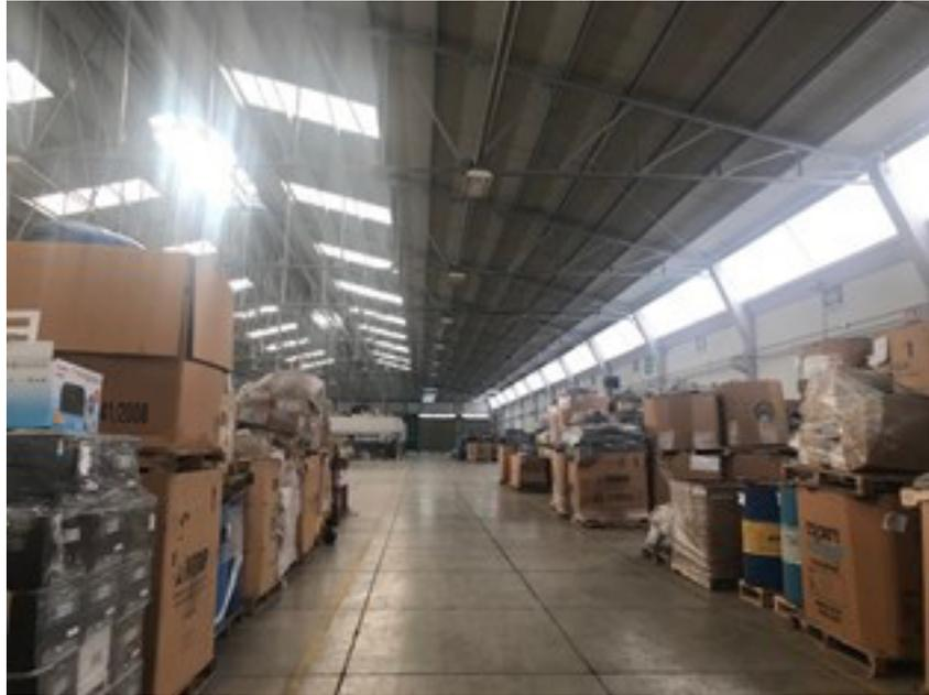
**Figure 28** – Stockage des déchets électroniques dans des cartons sous zone couverte avec sol en béton, marquage/signalisation, et ventilation ©Deepali Sinha Khetriwal
