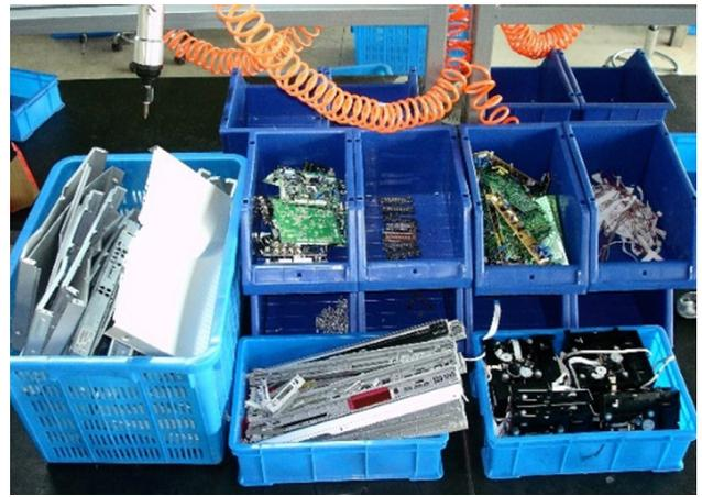
Figure 25 – Exemples de bonnes pratiques de stockage des DEEE et leurs fractions ©UNITAR
