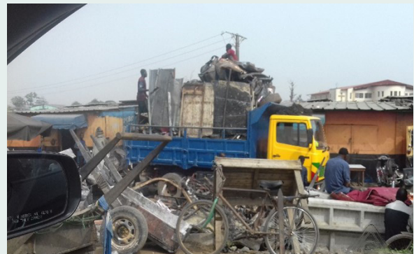
Figure 7 - Exemples de mauvaises pratiques de stockage des VFV ©MINEDD
