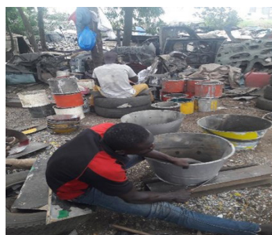
Figure 5 - Réutilisation de la tôle des VFV dans la production de nouveaux articles ©MINEDD
