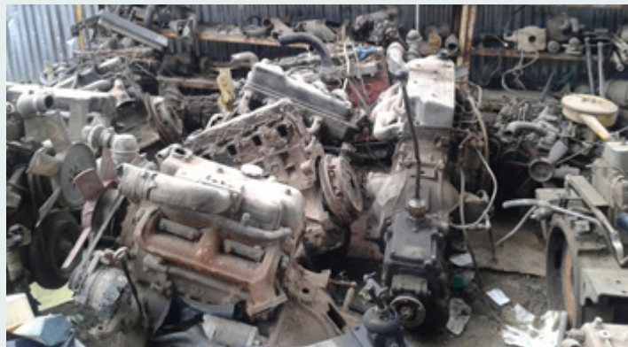
Figure 8 - Exemples de mauvaises pratiques de stockage des composants de VFV @Keshav Parajuly
