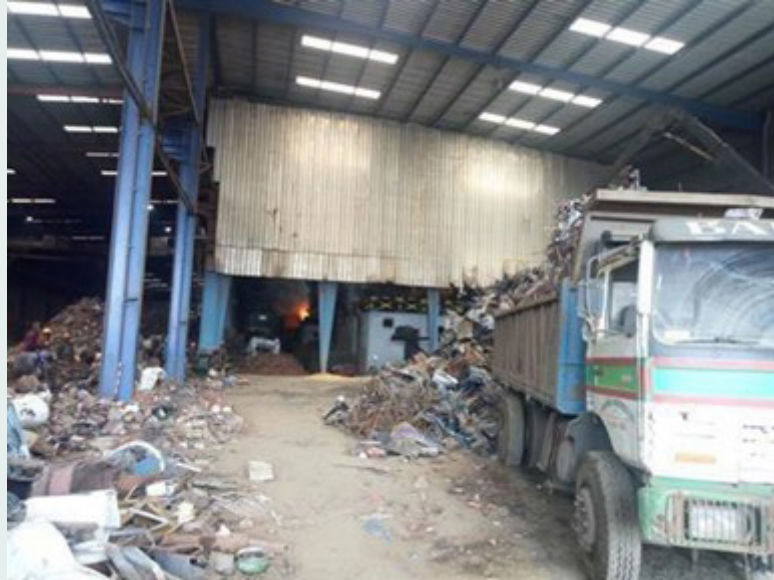
Figure 9 - Exemple de mauvaise pratique : plastique apporté à l'aciérie avec de la ferraille ©GEF, 2018
